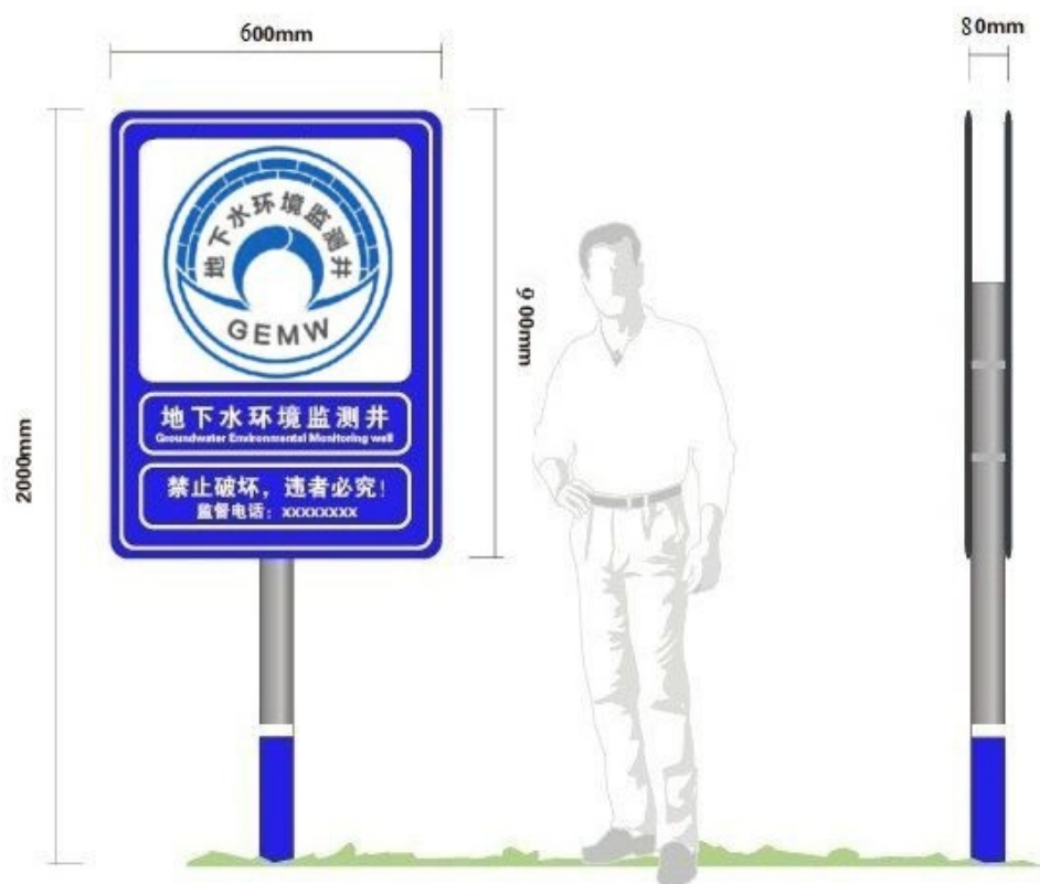
图 A.3 地下水监测井警示标图示及尺寸
